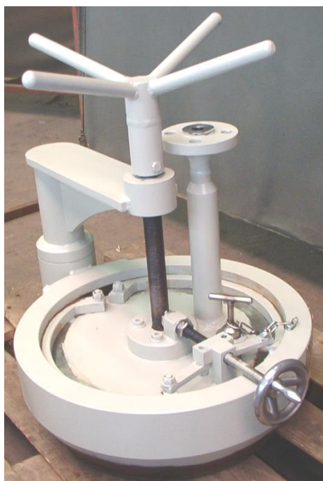
Clôture du segment SSV-DN 500
