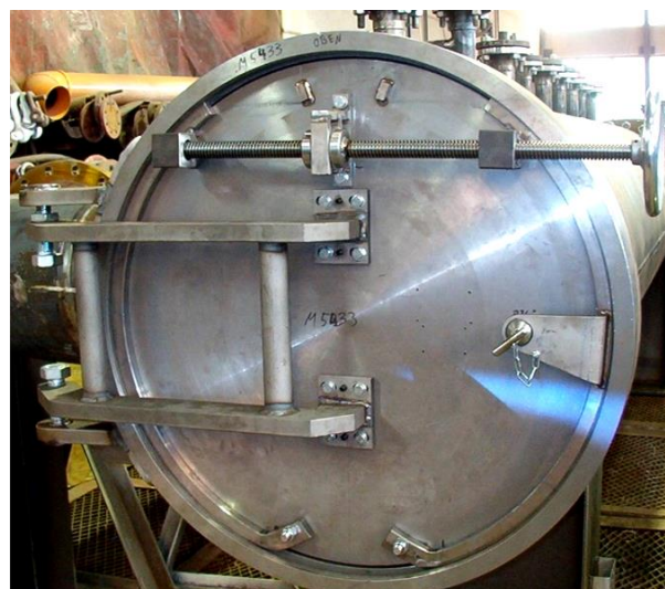
Clôture du segment SSV-DN 1200
