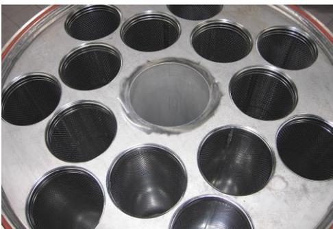
Aufnahmeplatte mit Stützkörben für 14 Filterbeutel
